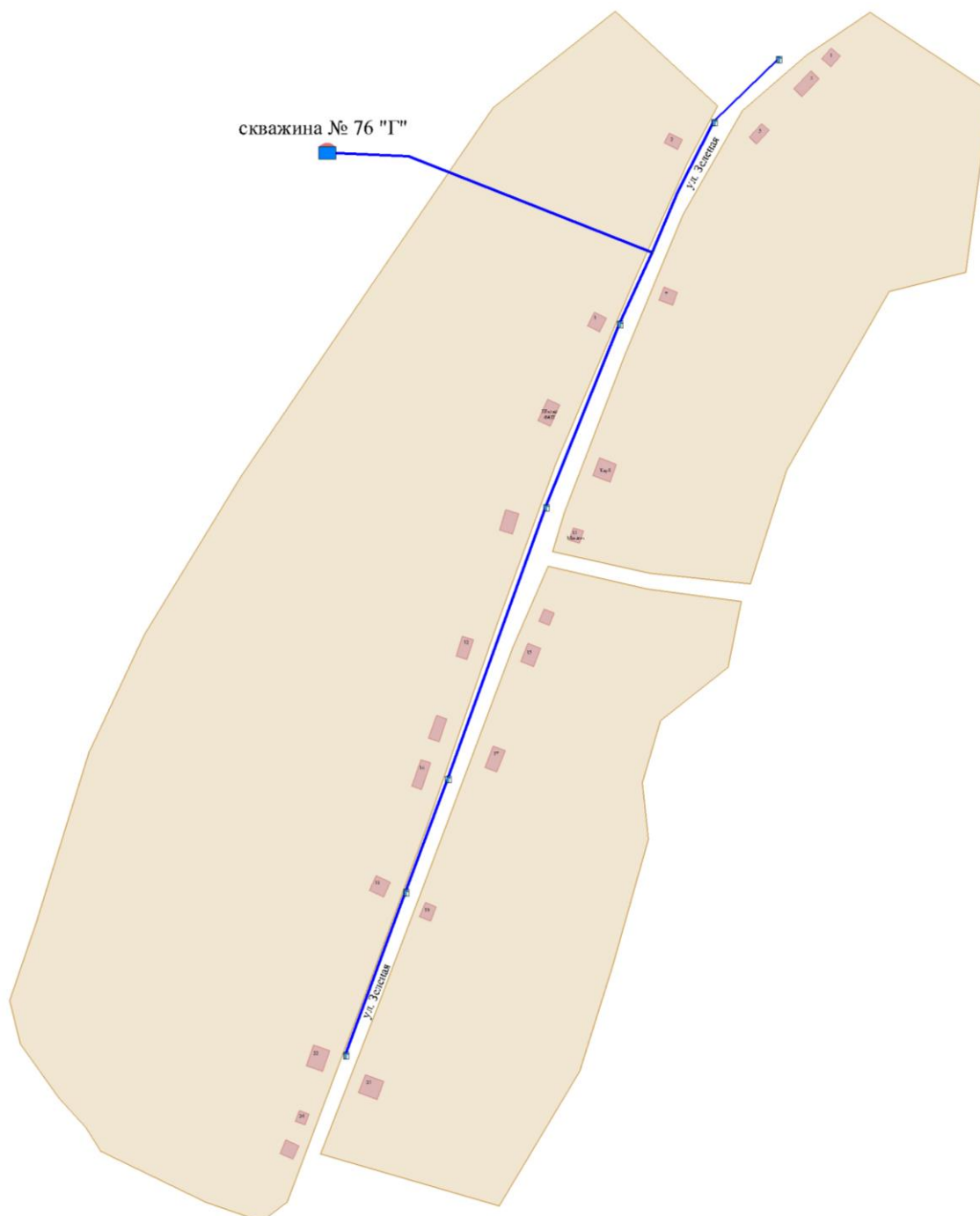
Рисунок 5.2 – Схема существующего размещения объектов централизованной системы водоснабжения
